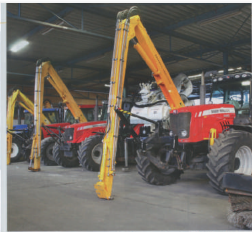
Een simpele oplossing bestaat uit een tractor van bedrijf A en een maaiern van bedrijf B, zelf aan elkaar gekoppeld.
